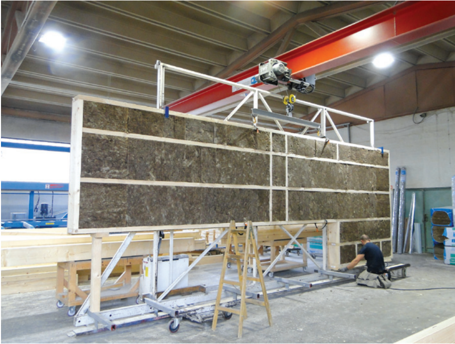
14: Element medetažne konstrukcije z vgrajeno toplotno izolacijo iz kamene volne
