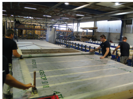
8: Pomemben sestavni del zunanega ovoja je parna ovira na notranji strani stene, ki je tudi v funkciji zrakotesne ravnine.
