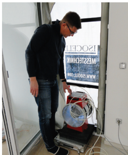
Rezultat testa zrakotesnosti na pasivni hiši v Rožni dolini – n_{50} = 0,34 \text{ h}^{-1} – v eni uri se bo pri 50 Pa podtlaka ali nadtlaka zamenjalo 34 odstotkov zraka (minimalna zahteva je sicer n_{50} \leq 0,6 \text{ h}^{-1} )
