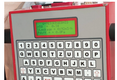
Rezultat testa zrakotesnosti na pasivni hiši v Rožni dolini – n_{50} = 0,34 \text{ h}^{-1} – v eni uri se bo pri 50 Pa podtlaka ali nadtlaka zamenjalo 34 odstotkov zraka (minimalna zahteva je sicer n_{50} \leq 0,6 \text{ h}^{-1} )
